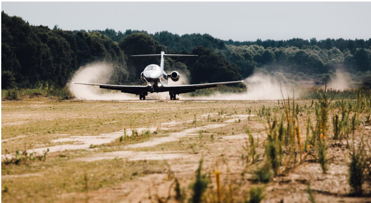
Campagne de certification du PC-24 sur des terrains non revêtus (source Pilatus)
