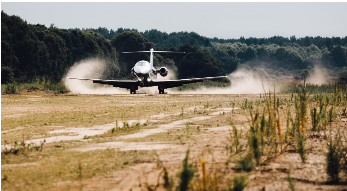
PC-24 Zertifizierungskampagne auf unbefestigtem Gelände (Quelle Pilatus)
