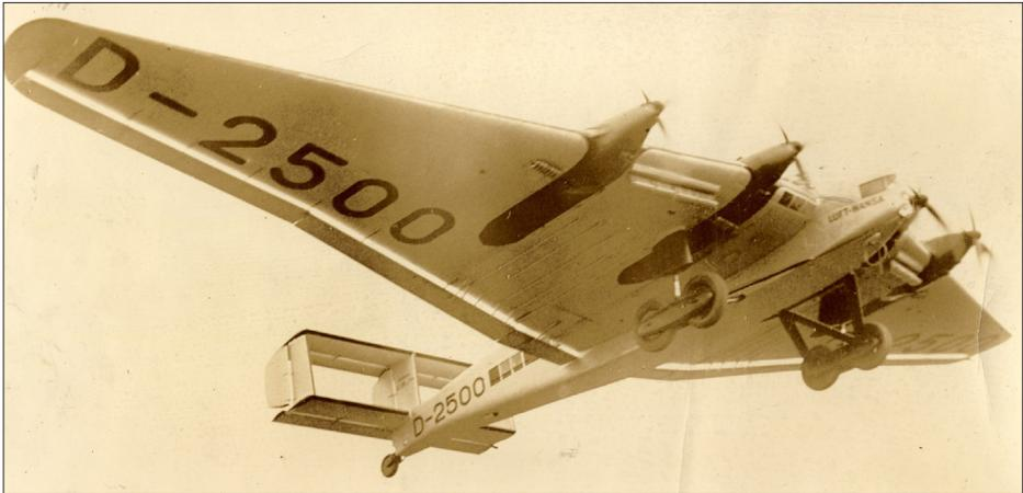
*Presseaufnahme um 1932 der Associated Press Photo. Die G 38ce (D-2500) kurz nach dem Start in Berlin (Tempelhof). Deutlich zu sehen ist das Kastenleitwerk.*
